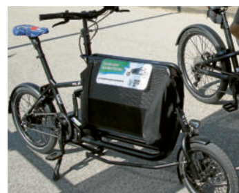
Zweirädriges Lastenpedelec. Keine Kindermitnahme möglich. Lastenkorb: max. 70 kg
