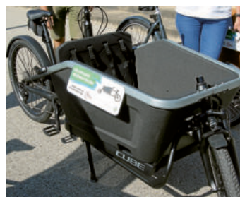
Zweirädriges Lastenpedelec. Kindermitnahme möglich. Max. Zuladung 60 kg
